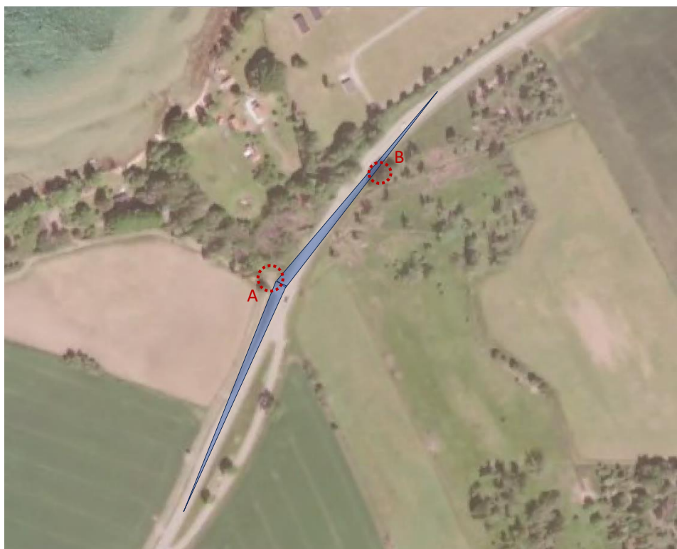
Figur 5. Uppskattade sikttrianglar för korsning vid Tegelbruket, normal standard hastighet 80 km/h. Identifierade områden som behöver ses över A) och B).
